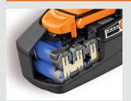
En cas de surcharge, le système électronique de protection dans la batterie arrête la visseuse via une liaison de communication distincte. L'outil électroportatif redevient ensuite immédiatement opérationnel.
