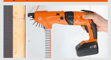
Les visseuses FEIN pour la pose de cloisons sèches réalisent plus d'un million de vissages – et ce sans aucun entretien. Cela correspond à une surface de plus de 40 000 mètres carrés pour 25 vis par mètre carré.
