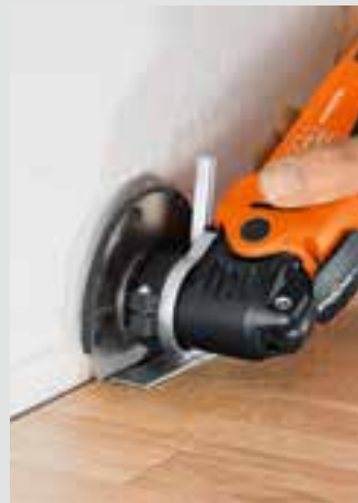
Tarkkaa työskentelyä reunan lähellä myös syvyysrajoitinta käytettäessä.
