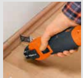
Työstettävän kappaleen takana ei tarvita vapaata tilaa.
