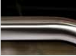
Situation initiale: tube préponcé avec le grain 400.
