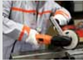
Étape 3: poli miroir ou fourbissage avec un disque de polissage tissu rigide Ø 150 mm et la pâte à fourbir (vitesse de rotation recommandée 2500 tr/min, pos. 6).
