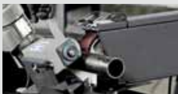
Étape 2 : finition avec la bande abrasive en liège GRIT en combinaison avec une lubrification (vitesse de rotation recommandée 1500 tr/min, vitesse 1).
