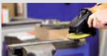
Application : ponçage du cordon de soudure.
