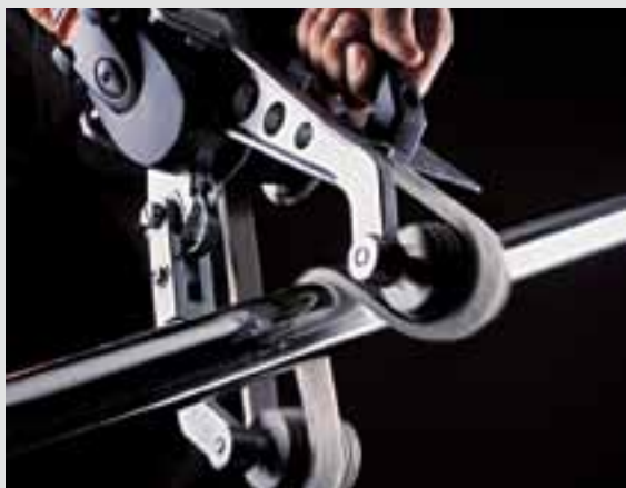
Poli spéculaire d'un tube en acier inoxydable avec la ponceuse pour tubes RS 12-70 E.
