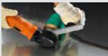
Application : Ponçage du cordon de soudure avec un manchon abrasif et une roue à expansion avec une vitesse de rotation maximale de 2500 tr/min (pos. 6).
