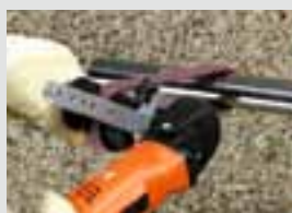
Étape 3 : satinage avec la bande fibre fine (vitesse de rotation recommandée 2200 tr/min, pos. 4).
