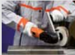
Étape 2: polissage avec un disque de polissage tissu rigide Ø 150 mm et la pâte de prépolissage (vitesse de rotation recommandée 2500 tr/min, pos. 6).
