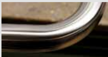
Résultat : malgré le mouvement de rotation aucune trace à la surface grâce au disque de finition élastique.
