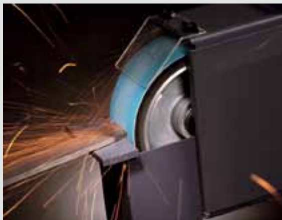
Préparation pour cordon de soudure sur une arête.
