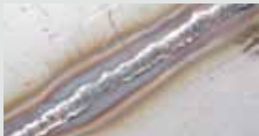
Situation initiale : cordons de soudure fins.
