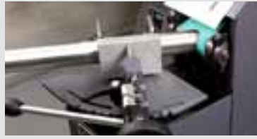
Application: grugeage du tube en quelques secondes (vitesse de rotation 1500 tr/min, vitesse 1).
