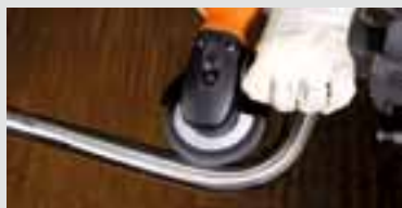
Application : finition avec le disque de finition Ø 125 mm (vitesse de rotation recommandée 3300-4200 tr/min, pos. 3).
