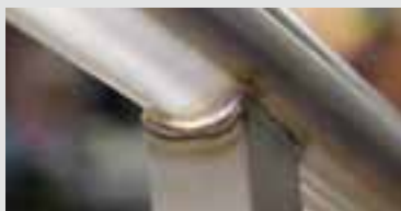
Situation initiale : élimination de couleurs de revenu sur les cordons de soudure fins.
