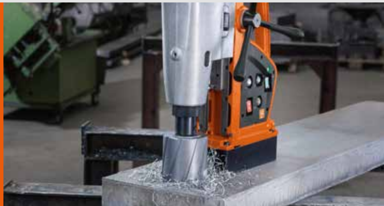
HM ULTRA 100 Kernbohrer mit Weldon 32-Aufnahme
