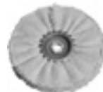
Filz Lamellenwalze Zum Polieren und Vorpulieren von Edelstahl. Durch die Lamellen „verbrennt“ der Filz nicht und es kann ohne Streifenbildung poliert werden. Nur mit Polierpaste verwenden (Vorpulieren = Vorpuliercreme, Hochglanzpolieren = Abglanzcreme).
