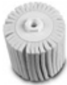
Filz Lamellenwalze Zum Polieren und Vorpulieren von Edelstahl. Durch die Lamellen „verbrennt“ der Filz nicht und es kann ohne Streifenbildung poliert werden. Nur mit Polierpaste verwenden (Vorpulieren = Vorpuliercreme, Hochglanzpolieren = Abglanzcreme).
