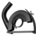
Saugenschutzhaube mit Führungsschlitten für Trennscheiben Ø 180 mm, Schnitttiefe 40 mm, Anschluss Ø 32 mm
