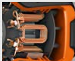
Borstlösa FEIN PowerDrive-motorer
