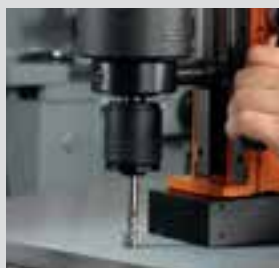
Gwintowanie aparatem do gwintowania
