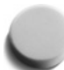
Esponja de pulir Para pulir superficies pintadas. Distintos grados de dureza: blando para pintura nueva, medio para corrosión ligera y capa de cera, duro para pinturas muy corroídas. Fijación rápida por velcro, altura 40 mm.
