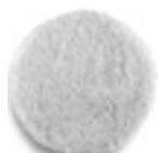
Tarcza wełniana Włóknina szlifierska do czyszczenia lub polerowania kadłubów łodzi i pokładów Ø 195 mm do talerza szlifierskiego Ø 170 mm 6 38 06 187 01 0 M 14 z mocowaniem na rzep. Do powierzchni antypoślizgowych z tworzywa wzmacnianego włóknem szklanym. Zalecana robocza prędkość obrotowa: ok. 500 obr./min.
