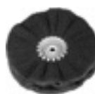
Włókno szlifierskie z zakładką falistą, szerokość ok. 30 mm, otwór 14 mm, do gratowania, usuwania zadziorów, lekkich prac szlifierskich, prac dekoracyjnych
