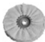
Walek listkowy filcowy Do polerowania i polerowania wstępnego stali nierdzewnej. Dzięki listkom filc nie „pali się”, co umożliwia polerowanie bez smug. Stosować wyłącznie w połączeniu z pastą polerską (polerowanie wstępne = pasta do polerowania wstępnego, polerowanie na wysoki połysk = pasta nabłyszczająca).
