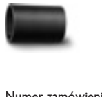
Złączka rurowa Uniwersalne rozwiązanie do łączenia elektronarzędzi i akcesoriów z odciąganiem pyłu na odkurzaczu. Elastyczna tulejka gumowa, długość 70 mm, średnica wewnętrzna 31,5 mm.
