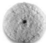
Tarcza wełniana Średnica ok. 230 mm do talerza szlifierskiego Ø 170 mm 6 38 06 187 01 0 M 14 z mocowaniem na rzep. Zalecana robocza prędkość obrotowa 500-1200 obr./min. Jakość TOPWOOL, tarcza polerska Frisbee. Mieszanka wełny jągnięcej/włókien syntetycznych, możliwość prania.
