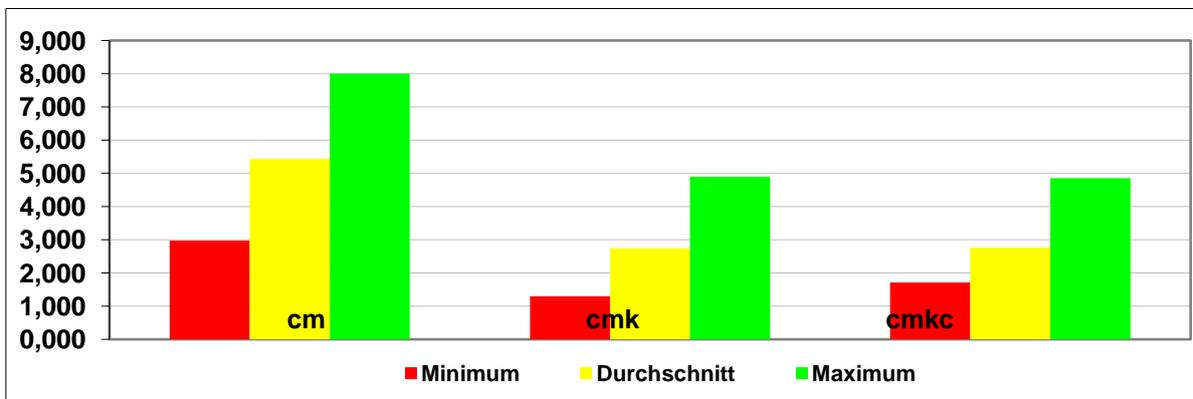
$c_m$ -,  $c_{mk}$ - und  $c_{mkc}$ -Werte über 3 Drehmomente (30%, 80%, 100%) und 2 Schraubfälle (30°, 360°) :
