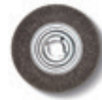
Oceľová kefa Ø 250 mm x 60 mm, s veľmi veľkou ťažnosťou drôtu pre obzvlášť hospodárne nasadenie, upínací otvor Ø 51 mm. Hrúbka drôtu 0,2 mm pre tenkostenné rúry a profily. Hrúbka drôtu 0,35 mm pre univerzálne použitie. Hrúbka drôtu 0,5 mm pre hrubostenné rúry a profily a vysoký výkon odstraňovania výronkov. Vyhotovenie z ocele
