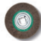
Oceľová kefa Ø 250 mm x 60 mm, s veľmi veľkou ťažnosťou drôtu pre obzvlášť hospodárne nasadenie, upínací otvor Ø 51 mm. Hrúbka drôtu 0,2 mm pre tenkostenné rúry a profily. Hrúbka drôtu 0,35 mm pre univerzálne použitie. Hrúbka drôtu 0,5 mm pre hrubostenné rúry a profily a vysoký výkon odstraňovania výronkov. Vyhotovenie z ušľachtilej ocele
