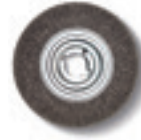
Çelik fırça Ø 250 mm x 60 mm, ekonomik kullanım için çok yüksek tel çekme sertliği ile, tutturma deliği Ø 51 mm. ince duvarlı boru ve profil için 0,2 mm tel kalınlığı Üniversal kullanım için 0,35 mm tel kalınlığı. Kalın duvarlı boru ve profil ve de yüksek verimlilik için 0,5 mm tel kalınlığı. Çelik serisi
