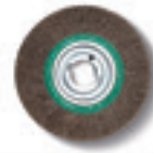
Çelik fırça Ø 250 mm x 60 mm, ekonomik kullanım için çok yüksek tel çekme sertliği ile, tutturma deliği Ø 51 mm. ince duvarlı boru ve profiller için 0,2 mm tel kalınlığı Üniversal kulla- nım için 0,35 mm tel kalınlığı. Kalın duvarlı boru ve profil ve de yüksek verimlilik için 0,5 mm tel kalınlığı. Paslanmaz-çelik-serisi
