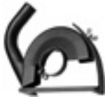
Emme emniyet başlığı \varnothing 180 mm ayırma diskleri için sevk kızaklı, kesme derinliği 40 mm, bağlantı \varnothing 32 mm
