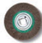
Perie de sârmă din oțel Ø 250 mm x 60 mm, cu o foarte mare rezistență la rupere a sârmei pentru o utili- zare deosebit de rentabilă, alezaj de fixare Ø 51 mm. 0,2 mm grosimea sârmei pentru țevi și profiluri cu perete subțire. 0,35 mm grosimea sârmei pentru uz universal. 0,5 mm grosimea sârmei pentru țevi și profiluri cu perete gros și o putere mare de debavurare. Sârmă din oțel superior
