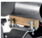
Șină conducătoare, alamă pentru rectificare uscată și materi- ale cu suprafețe grosiere
