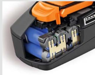
Bei Überlastung greift die Schutzelektronik im Akku und schaltet den Schrauber über eine separate Kommunikationsleitung ab. Das Elektrowerkzeug ist danach sofort wieder einsatzbereit.
