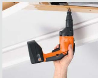
Mit nur 1,3 kg beim Netzschrauber und nur 1,7 kg bei der Akku-Version zählen die FEIN Trockenbauschrauber zu den leichtesten am Markt. Das ermöglicht ein nahezu ermüdungsfreies Arbeiten. Auch über Kopf und mit nur einer Hand.
