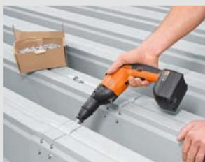
El tope de profundidad ajustable de 0,25 mm garantiza un asiento óptimo de las arandelas.
