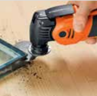
İzolasyon cam levhalarının ayrılması.
