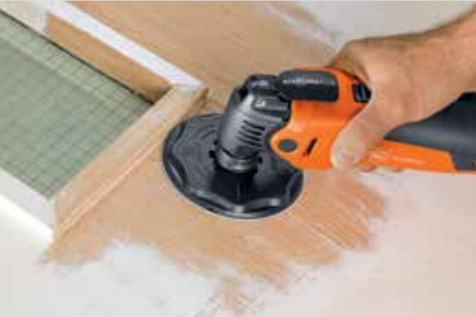
Büyük, yuvarlak zımpara tablası, eksantrik veya titreşimli zımpara gibi ilave zımpara makinelerinin yerini almaktadır.
