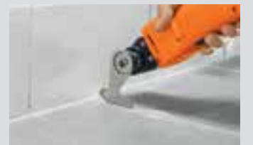
Köşe alanındaki kesimler için elmas segmentli bıçak.
