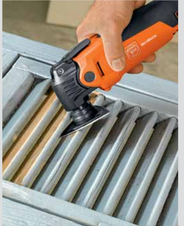
Dar ara boşluklar için düz zımpara tabanı.
