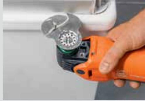
Birleşme derzlerinin çıkartılması.
