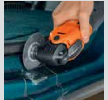
Çarpıklık olmadan, temiz kesim kenarları, ince kesim çizgisi - karser işlerinde bir avantaj.
