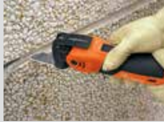
Çok derin derzler için uzun kesme bıçağı.
