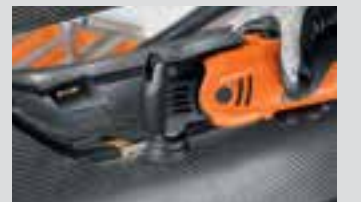
KTP yapı parçalarında çapak alma.
