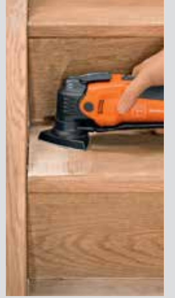
Köşe ve kenarlarda geri tepme etkisi olmaksızın zımparalama işleri.
