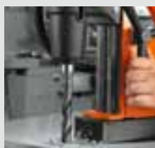
Perforación con broca espiral
