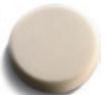
Esponja de pulir Para pulir superficies pintadas. Distintos grados de dureza: blando para pintura nueva, medio para corrosión ligera y capa de cera, duro para pinturas muy corroídas. Fijación rápida por velcro, altura 40 mm.
