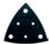
Hojas de lija, perforadas Para lijado con aspiración de polvo. De aplicación universal sobre casi todas las superficies. El granulado de corindón y su ligado con resina sintética maciza garantizan un alto rendimiento abrasivo. Desde gr. 36 a 240.
