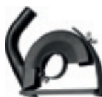
Carcasa de protección de aspiración con carro de guía para discos de tronzado de Ø 230 mm, profundidad de corte 65 mm, conexión de Ø 32 mm
