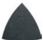
Set de hojas de lija Para la aplicación universal sobre casi todas las superficies. El grano de lijado de corindón y ligado con resina sintética maciza garantizan un alto rendimiento abrasivo. Cada uno con 10 hojas de lija, sin perforar, con fijación rápida de velcro, grano 60, 80, 120, 180, 240.
