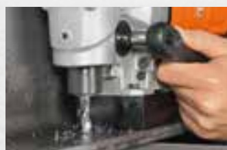
Perçage au foret hélicoïdal
