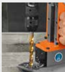
Perçage au foret hélicoïdal
