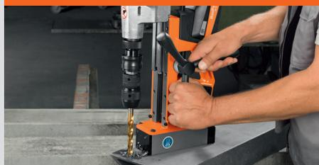
Double guidage du moteur de perçage idéal pour l'utilisation d'outils de perçage de grande taille. Réglable en continu et sans outil par levier de serrage.
