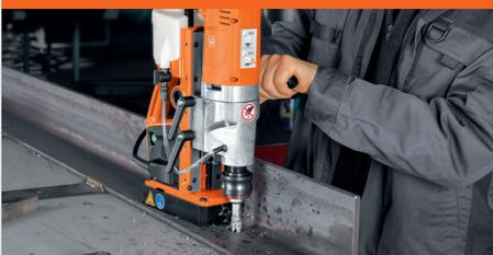
Perçage par carottage, perçage au foret hélicoïdal, taraudage, chanfreinage et alésage.
