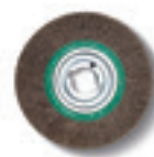
Szczotka stalowa Ø 250 mm x 60 mm, bardzo duża wytrzymałość drutu na zerwanie, bardzo ekonomiczna w zastosowaniu, otwór do mocowania Ø 51 mm. Grubość drutu 0,2 mm do cienkościennych rur i profili. Grubość drutu 0,35 mm do uniwersalnego zastosowania. Grubość drutu 0,5 mm do grubościennych rur i profili, duża wydajność usuwania zadziorów. Wykonanie ze stali nierdzewnej
