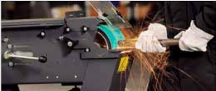
중하중용 고성능 벨트 그라인더. 모듈형 GRIT GI 프로그램의 기본형, 단일 또는 2단 속도 모델. 고성능 벨트 그라인더로 개별적으로도 사용 가능.
