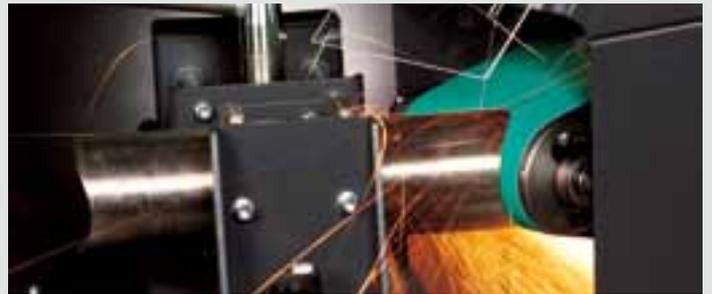
퀵 클램핑 시스템이 장착되어 있어 중하중 벤치 바이스를 사용하여 간단하고 합리적으로 가공물을 교체할 수 있습니다. 함께 제공된 스테인리스강 클램핑 조는 스테인리스강 가공물의 접촉 부식을 방지합니다. 효과적인 흡진을 위해서는 흡진장치(주문 번호 6 99 02 182 00 0)가 필요합니다.
