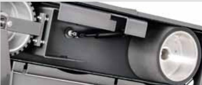
가스 서스펜션은 벨트의 크기 허용오차를 자동으로 맞춰줍니다. 폴리우레탄으로 코팅된 구동 폴리와 결합하여 벨트를 최적으로 상태로 고정합니다. 미끄러짐이 없습니다.
