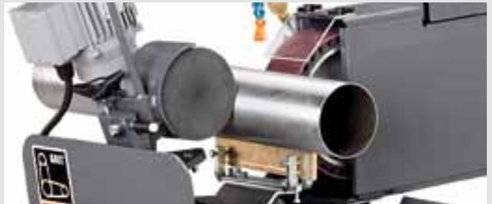
공급 품목에는 가공물의 표면 품질에 맞출 수 있도록 여러 종류의 가이드 레일이 포함되어 있습니다. 황동 가이드 레일은 부식면, 산화막 등과 같은 거친 표면이나 건식 연마를 위해 설계된 구성품입니다. 표면 마무리와 민감한 소재를 다루기 위해서는 나일론 레일이 가장 적합한 장비입니다.
