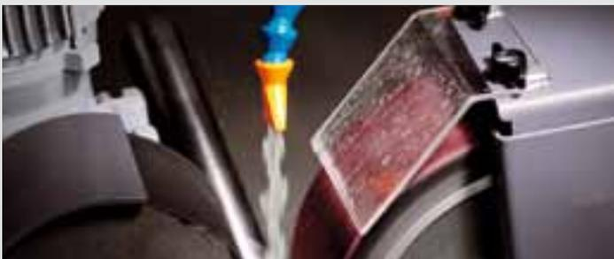
GRIT GXW 냉각 윤활 모듈을 사용한 습식 연마로 표면 처리가 상당히 개선되었습니다. 즉 연마 분진을 즉시 굳히고, 냉각하여 그라인더의 벨트 수명을 연장합니다. 또한 연마할 때 발열을 줄여 스테인리스강 파이프가 부식할 위험도 줄입니다. 윤활제가 순환하기 때문에 냉각 윤활제의 소비량도 절약할 수 있습니다.
