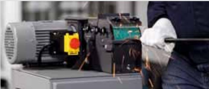
소형 부품의 연삭, 모따기 및 면취에 이상적인 장비. GRIT GIXBE 장비 받침대와 결합하여 미세분진 필터를 통해 연삭 분진을 흡입합니다.
