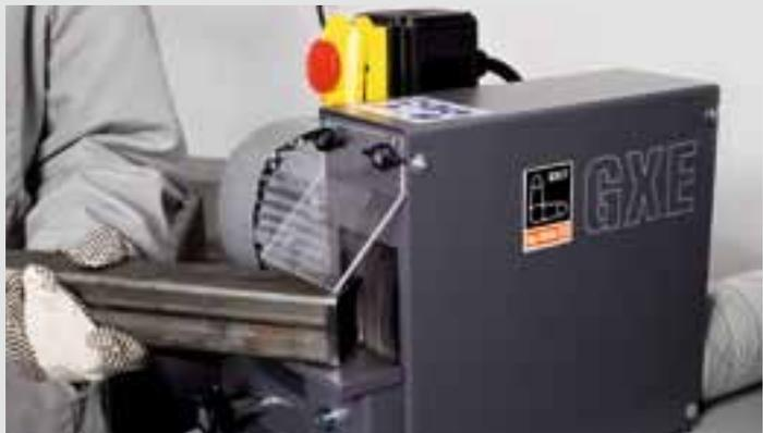
브러시를 사용하여 강철 및 스테인리스강 가공물을 면취하기 위한 GRIT GX 프로그램의 독립된 보완 모듈. 선택 사양으로 장비 받침대 장착 가능.
