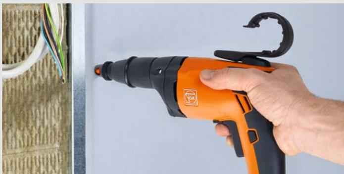
Le lastre in gesso ad alta densità richiedono avvitatori particolarmente potenti. Con gli avvitatori per cartongesso FEIN si possono lavorare senza fatica perfino lastre in gesso rivestite ad alta densità accoppiate. Lo stesso vale naturalmente anche per le lastre in cartongesso.
