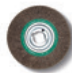
Acélkefe Ø 250 mm x 60 mm, a nagy szakítási- szilárdság különösen gaz- daságos alkalmazást tesz lehetővé, befogófurat Ø 51 mm. 0,2 mm hu- zalvastagság vékonyfalú csövekhez és profilokhoz. 0,35 mm huzalvastagság univerzális alkalmazáshoz 0,5 mm huzalvastagság vastag falú csövekhez és profilokhoz, nagy sorjázási tel- jesítmény. Rozsdamentes kivitel
