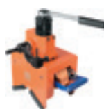
Befogó- és előtolókészülék 280 x 285 x 395 mm (szélesség x mélység x magasság), 80 és 400 mm közötti külsőát- mérőjű csövekhez és körprofilú anyagokhoz
