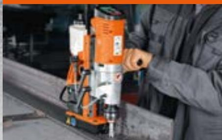
Foratura con punte a corona o elicoidali, maschiatura, svasatura e alesatura con un unico utensile.
