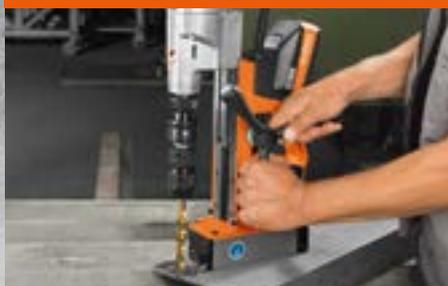
Doppia guida a coda di rondine del motore ideale per l'impiego di grandi utensili di foratura. Regolabile in continuo e senza chiavi di servizio mediante leva di bloccaggio.
