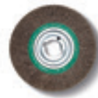
Teräsharja Ø 250 mm x 60 mm, erinomainen te- räslangan lujuus erityisen taloudelliseen käyttöön, kiinnitysporaus Ø 51 mm. Teräslangan paksuus 0,2 mm ohutseinäi- sille putkille ja profileille. Teräslangan paksuus 0,35 mm yleiskäyttöä varten. Teräslangan paksuus 0,5 mm pak- suseinäisille putkille ja profileille suurta jäy- steenpoistotohoa varten. Jaloteräsmalli
