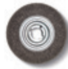
Teräsharja Ø 250 mm x 60 mm, erinomainen teräslangan lujuus erityisen talou- delliseen käyttöön, kiinnitysporaus Ø 51 mm. Teräslangan paksuus 0,2 mm ohutseinäisille putkille ja profileille. Teräslangan paksuus 0,35 mm yleiskäyttöä varten. Teräslangan paksuus 0,5 mm pak- suseinäisille putkille ja profileille suurta jäysteenpoistotohoa varten. Teräsmalli
