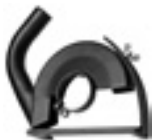
Imusuojus ohjauskelkalla, leikkaussyvyys 40 mm, liitäntä Ø 32 mm
