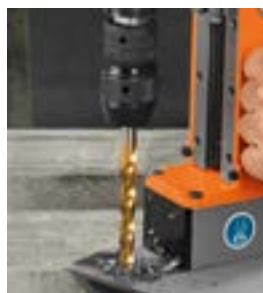
Perçage au foret hélicoïdal
