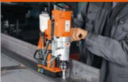
Kernbohren, Spiralbohren, Gewindebohren, Senken und Reiben mit einer Maschine.
