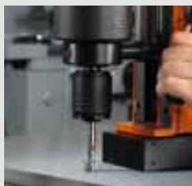
Řezání vnitřního závitu se zařízením na řezání závitů
