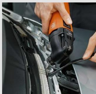
Mit dem Schabmesser entfernen Sie Restkleber sauber, schnell und ohne Kraftaufwand.
