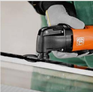
Das pilzförmige Schneidmesser trennt Isolierglasscheiben von Bussen und Bahnen bequem und schnell. Auch Klebereste am Glas können damit einfach entfernen werden.
