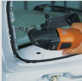
Bei einigen VAG-Modellen sind die Heck- und Seitenscheiben mit anvulkanisierten Rahmen ausgestattet. FEIN bietet Ihnen die perfekte Lösung, um die Scheiben der VW Passat Variant-Modelle bis 2004, von VW Polo bis 2001, Lupo, Seat und VW Golf III beschädigungsfrei auszubauen.
