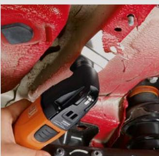
Mit dem Spachtel entfernen Sie Unterboden- und Steinschlagschutz einfach und schnell. So können Reparaturstellen problemlos freigelegt und z. B. Anhängerkupplungen direkt mit dem Rahmen verschraubt werden.
