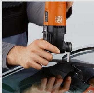
Gekapselte Windschutzscheiben und anvulkanisierte Rahmen, auch mit Aluminium-Verstärkung, lassen sich mit dem L-Messer in einem Arbeitsgang austrennen.
