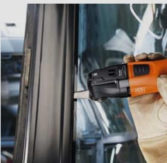
Die in Stufen oder U-Profilen verklebten Scheiben lassen sich mit dem Schneidmesser Form 177 mit einer Winkelschneide von 8mm auch an den Kanten austrennen. Bestens geeignet für Bus- und Bahnfenster.
