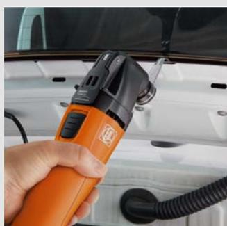
Gekapselte Seiten- und Heckscheiben lassen sich mit L-Messern in drei unterschiedlichen Längen bis 38mm von innen ausblasen.
