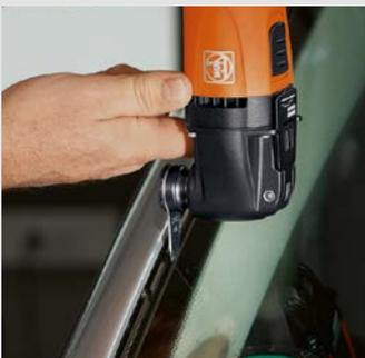
Mit dem L-Messer haben Sie bei gleicher Geschwindigkeit eine um 40 % höhere Schnittleistung als bei einem vergleichbaren U-Messer. Beschädigungen an der Karosserie sind nahezu ausgeschlossen.
