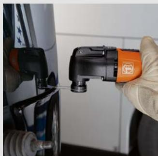
Bei LKW- und Bus-Scheiben mit geringen Spaltmaßen zwischen Glas und Rahmen kommen die L-Messer Form 207 und 209 zum Einsatz. Damit durchtrennen Sie auch fest montierte Leisten einfach und schnell. Empfohlene Geschwindigkeit Stufe 4–5.
