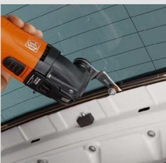
Mit dem Schneidmesser Form 143 und verstellbarer Anschlagrolle lassen sich Seiten- und Heckscheiben einfach und schnell von innen ausglasen.
