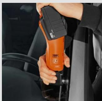
Extrem schneller Schnitt: das L-Messer Form 207 hat bei der gleichen Geschwindigkeitsstufe eine um 40% höhere Schnittleistung als ein vergleichbares U-Messer. Ein großer Vorteil beim Ausblasen von Windschutzscheiben von außen. Empfohlene Geschwindigkeit: Stufe 3–4.
