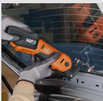
Das Messer mit der Form 143 ist mit einer verstellbaren Anschlagrolle ausgestattet. Dadurch lassen sich Scheiben schnell und sicher von innen austrennen. Empfohlene Geschwindigkeit: max. Stufe 3.
