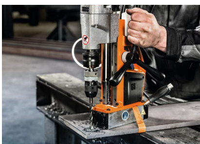
Bildunterschrift: Großer Hubbereich für den Einsatz langer Bohrwerkzeuge.
