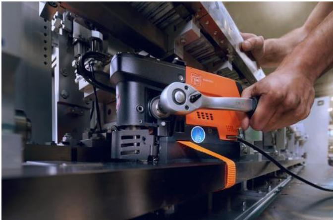
Bildunterschrift: Der hohe Getriebebestand der MAGFORCE sorgt für eine gute Sicht auf das Bohrwerkzeug und auf die Bohrstelle.
