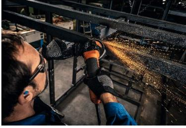
Bildunterschrift: Umfangreicher Anwenderschutz: Metallarbeiter werden durch eine Rückschlagüberwachung, einen Wiederanlaufschutz, Sanftanlauf und Anti-Vibrationshandgriff unterstützt.
