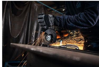
Bildunterschrift: Die neuen FEIN Compact-Winkelschleifer eignen sich für effektive Trennarbeiten. Trennschutzhauben sowie Trennscheiben mit Stärken von 1 oder 2,5 mm bieten Anwendern maximale Flexibilität bei Trennarbeiten.
